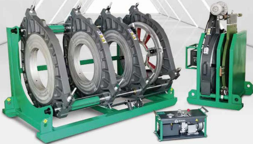
Las máquinas de termofusión manuales hidráulicas de la serie V fusionan tuberías de PE, PP, PPR y PVDF, y accesorios de termofusión. Sus componentes de calidad garantizan una larga vida útil, bajo mantenimiento y una operación confiable. Se puede instalar un registrador de datos para certificar la calidad de la soldadura.
